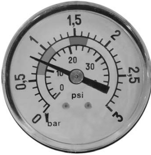
0,8 kg/cm 2 - 11,4 PSI: filitreleme sürecinin başındaki normal basınç
